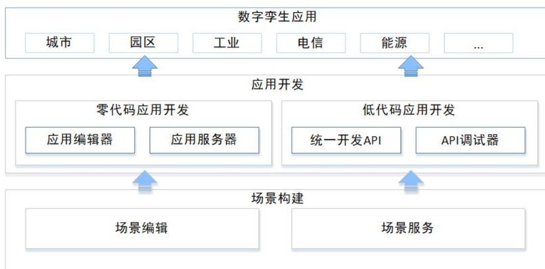
图1 数字孪生低代码平台技术框架
